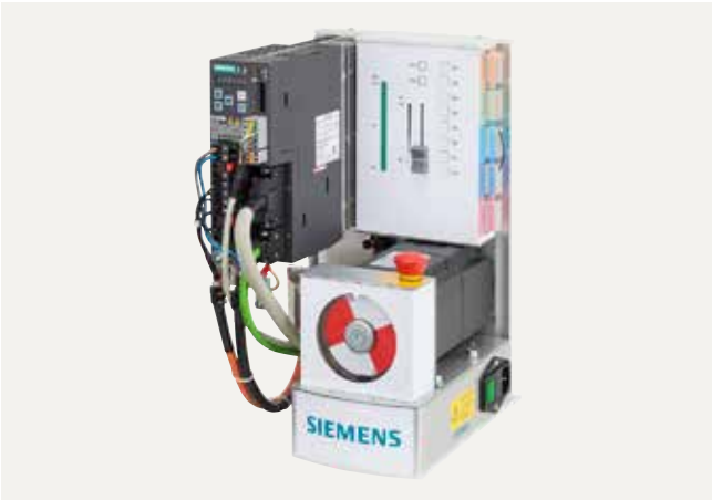
示例：SINAMICS V90 培训箱，脉冲序列（PIT）版本，不含 SIMATIC 控制器
