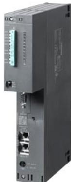
SIMATIC S7-400, CPU 416-3 PN/DP 中央处理器, 带: 工作存储器 16 MB, (8 MB 代码, 8 MB 数据), 接口 第 1 个 MPI/DP 接口 12 MBIT/S(X1), 第 2 个以太网/PROFINET 接口(X5) 第 3 个 IF 964-DP 接口可插拔(IF1)
