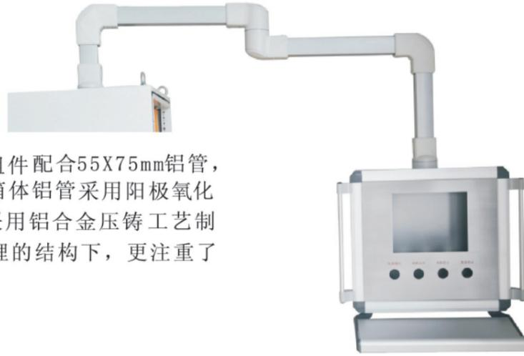
该系列中型悬臂组件配合55X75mm铝管，用于悬挂或支撑控制箱体铝管采用阳极氧化表面处理，组件全部采用铝合金压铸工艺制造，在保证强度及合理的结构下，更注重了外观的特有风格。
