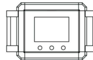
特别说明: JZ105悬臂箱, 只能搭配44/60轻型悬臂组件使用; JZ200前开门悬臂箱不能做面板抽屉; 悬臂箱可接受定制如: 面板丝网印刷、腐蚀刻字、配显示器支架、安装板、风扇等。
