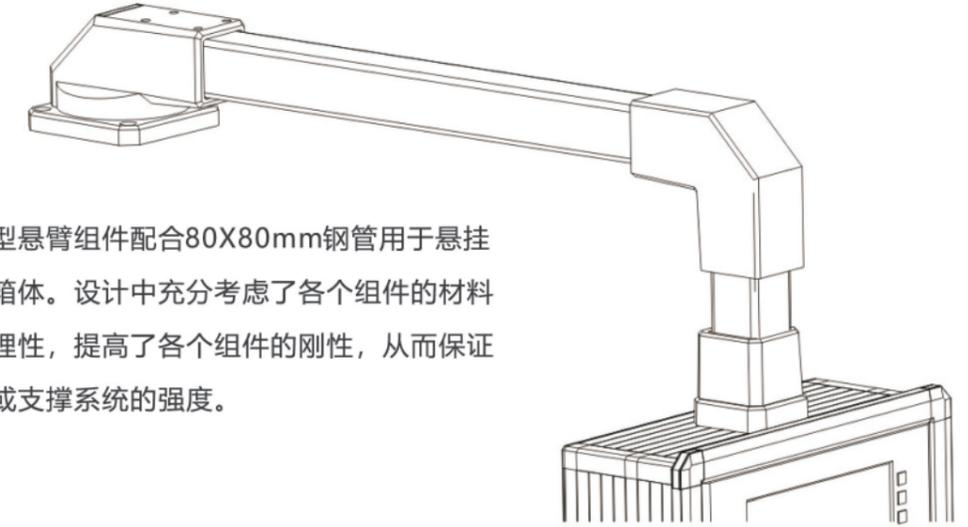
该系列经济型悬臂组件配合80X80mm钢管用于悬挂或支撑控制箱体。设计中充分考虑了各个组件的材料和结构的合理性,提高了各个组件的刚性,从而保证了整个悬臂或支撑系统的强度。
