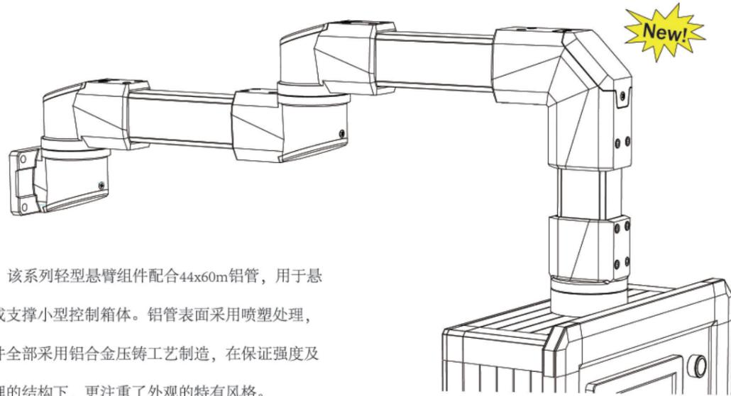
该系列轻型悬臂组件配合44x60mm铝管，用于悬挂或支撑小型控制箱体。铝管表面采用喷塑处理，组件全部采用铝合金压铸工艺制造，在保证强度及合理的结构下，更注重了外观的特有风格。
