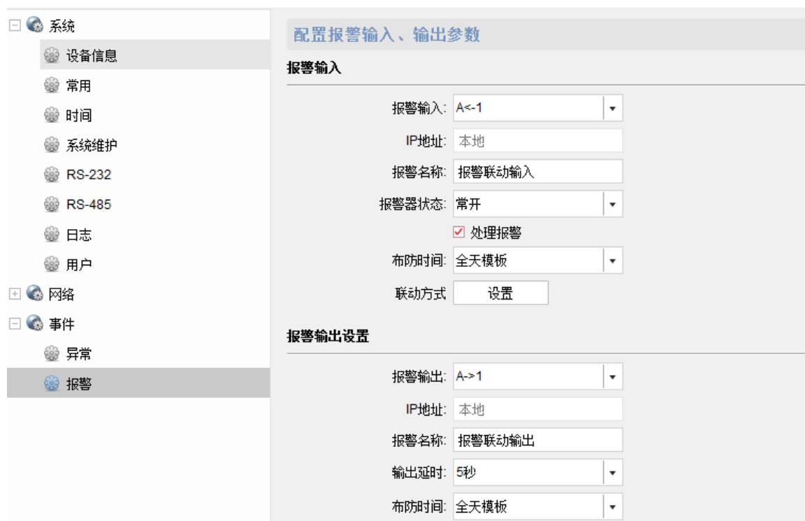
图4-54 配置报警输入、输出参数
