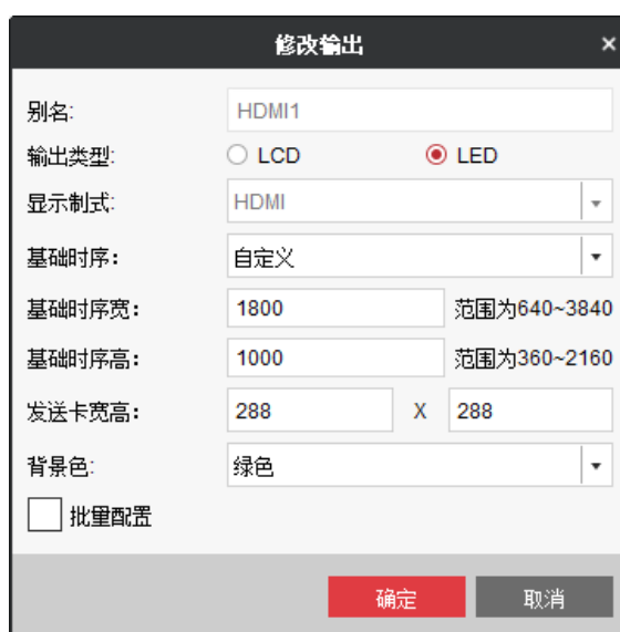
图4-5 设置 LED 输出分辨率
