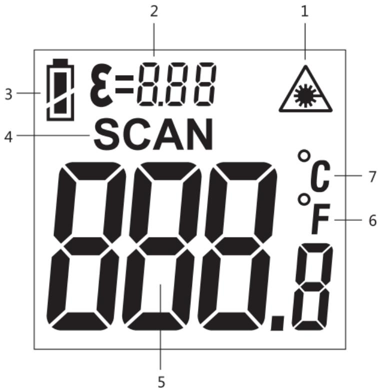
1. 激光功能指示符，表示激光功能已开启。
