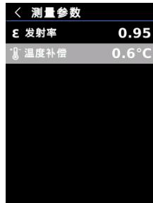
进入设置菜单后，按上/下按键选择测量参数设置选项，短按SET键进入测量参数设置，按上/下按键选择发射率或温度补偿，选择后短按SET键进入设置，按上/下按键可以进行加减数值，设置完毕后短按SET键保存参数，短按返回键返回上级菜单。
