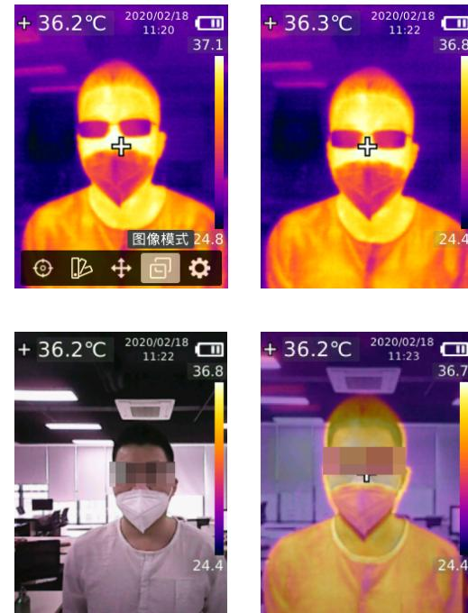
在热成像主测试页面，按SET键调出主菜单栏，按左/右按键选择图像模式配置选项 ，短按SET键进入图像模式选择菜单，按上/下按键选择不同图像模式，图像模式有热成像、数码相机(可见光)、融合，选择后短按SET键应用当前模式，短按返回键返回主菜单栏及热成像页面；在融合成像模式下，返回成像主页面后，可以通过按左/右按键选择不同融合比例，融合比例有：0% (全可见光)，25%，50%，75%，100% (全热成像)。
