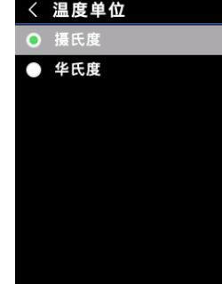
进入设置菜单后，按上/下按键选择温度单位设置选项，短按SET键进入温度单位设置，按上/下按键选择不同的温度单位，短按SET键保存设置值，设置完毕后短按返回键返回上级菜单。
