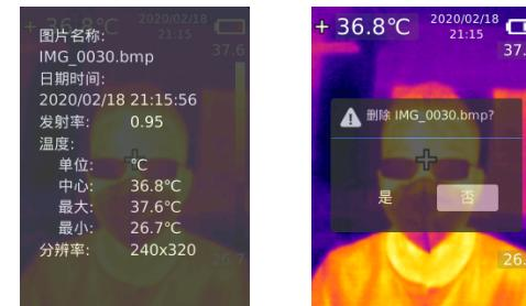
短按照片浏览按键进入照片浏览界面，通过上/下/左/右按键可以选择不同照片，短按SET键进入全屏浏览。在全屏浏览模式下，点SET键进入图像信息浏览及图像删除。
