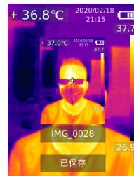
短按拍照扳机按键，进行图像拍照；手动保存模式下通过左/右按键选择是否保存图像，并按SET键确认或按返回键返回取消本次拍照。自动保存模式下，图像会自动保存到SD卡。
