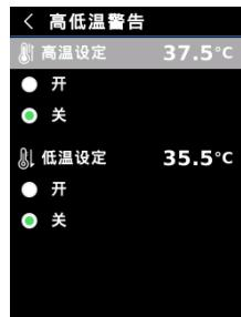
进入设置菜单后，按上/下按键选择高低温警告设置选项，短按SET键进入高低温警告设置，按上/下按键选择不同的设置项，可以分别打开或关闭高低温警告并设置温度值，选择温度值短按SET键进入设置值，按上/下按键可以进行加减数值，设置完毕后短按返回键保存设置值并返回上级菜单。当打开警告后，当温度超出所设定范围会发出警告。
