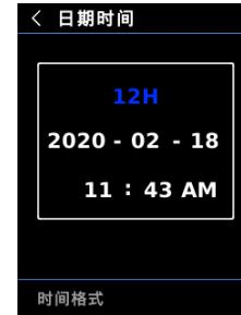
进入设置菜单后，按上/下按键选择日期时间设置选项，短按SET键进入日期时间设置，通过左/右键选择不同的时间节点和时间格式，短按SET键选定时间节点，按上/下按键可以进行加减时间，短按SET键保存设置值，设置完毕后短按返回键返回上级菜单。
