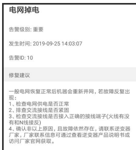
图 7-9 故障告警记录
