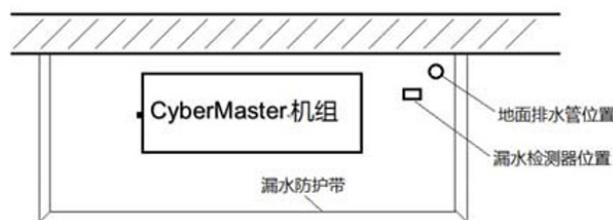
图 5-1 建议安装漏水传感器的位置
