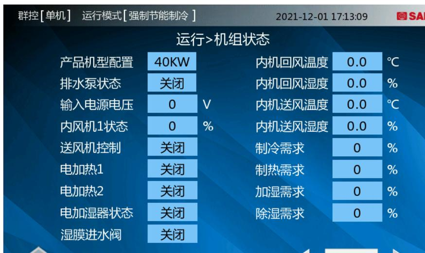
该界面显示了机组状态的详细数据。顶部显示“群控[单机] 运行模式[强制节能制冷]”和日期时间“2021-12-01 17:13:09”。标题为“运行>机组状态”。
