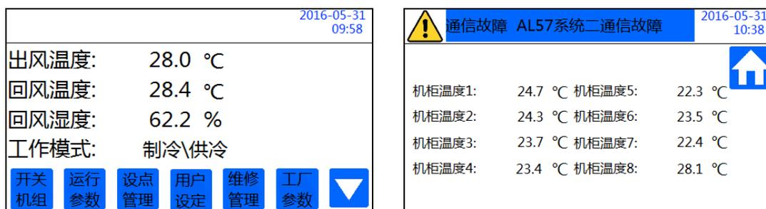
主页面中，有机组出风温度、回风温度、回风湿度、和工作模式的显示。其中机组的工作模式包括：制冷/供冷、除湿、BMS 关机、界面关机、故障关机和远程关机。主页右上角为日期和时间显示（适用于所有页面）。主页下方有 6 个子页面图标，点击后可以分别进入各自的子页面中。点击最右侧的向下箭头图标可以进入附页，附页中会显示机组所配置 8 个温度探头的温度。点击附页右上方的返回主页图标可以返回到主页。
