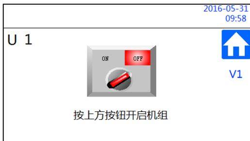
在主页面中点击“开关机组”图标后进入开关机组页面。开关机组页面共有 1 页，编号为 V1。页面正中是机组开关图标，点击图标任意位置弹出确认窗口，确认后可以实现机组开、关状态的切换。页面右上方是机组监控地址显示。
