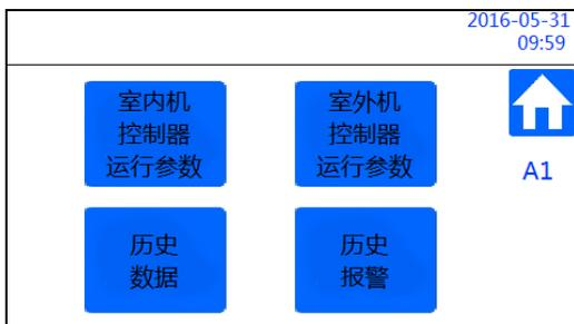
在主页面中点击“运行参数”图标进入运行参数页面，运行参数页面共有 12 页，编号为 A1, A2, ..., A12。运行参数有 4 部分：室内机参数，室外机参数，历史数据和历史报警。点击图标后可以进入各自的页面。
