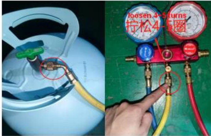
● 图 5-5 连接制冷剂罐
