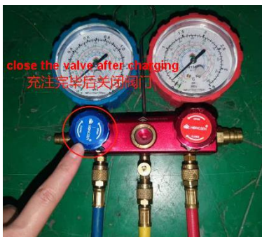
● 图 5-7 关闭低压充注阀
