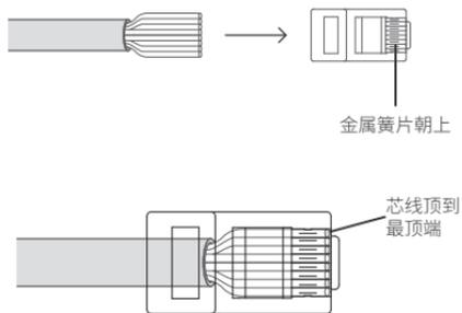
5.将水晶头放入网线钳压实，注意将网线外皮压入水晶头内，以确保牢固。用力拽水晶头，若没有脱落，则表明装配成功。
