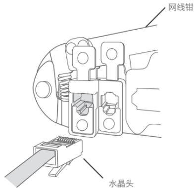
注：对于屏蔽类水晶头，请确保水晶头金属外壳与线缆接地线保持良好导通。
