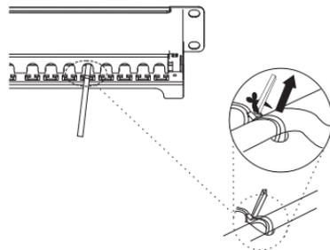
4. 将剥开的4对双绞线芯线分开, 将导线预埋入端子内, 使用专业的打线工具将双绞线压入端子底部, 并将多余的线头剪齐, 然后盖上屏蔽遮盖。
