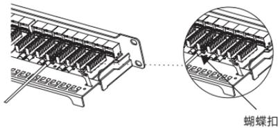
5. 用扎线带将线缆固定到托架上。
