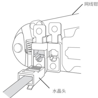
4.左手拿网线，注意线序从左到右正确排列，右手拿水晶头，金属簧片朝上，将排列好的网线顺序插入水晶头。注意确保每根芯线都要插入水晶头里对应的缝里，并且顶到最顶端。
