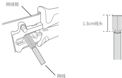
5.将水晶头放入网线钳压实，注意网线外皮放入水晶头内，否则会不牢固。用力拽扯水晶头，不会脱落说明成功装配。
